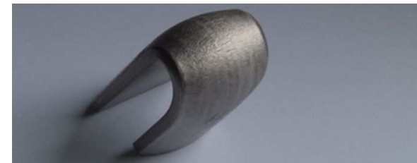
Proefstuk met interkristallijne scheuren
