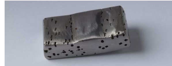
Proefstuk met pitting
